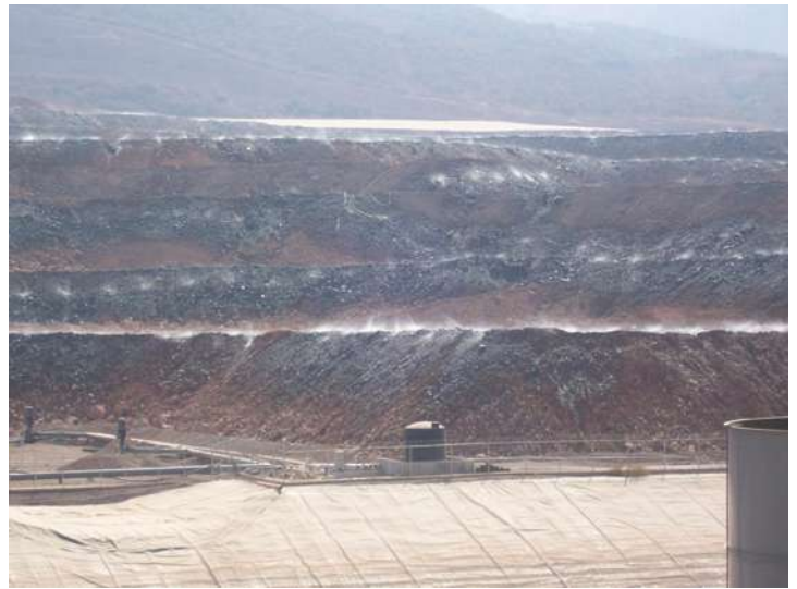
Colocación de Material y Riego con Cianuro de Sodio en el Patio de Lixiviados
